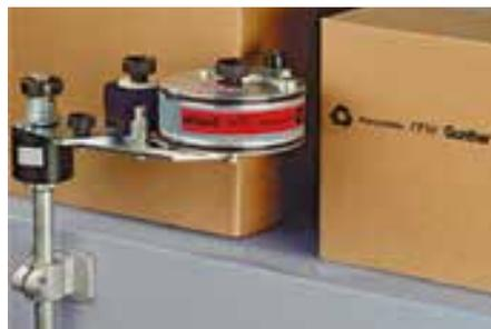
Rollerpack für die Verpackungskennzeichnung
