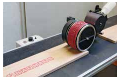
Rollstempel für Fertigungsbänder
